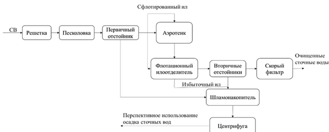
Схема очистки сточных вод плодовоовощного завода
