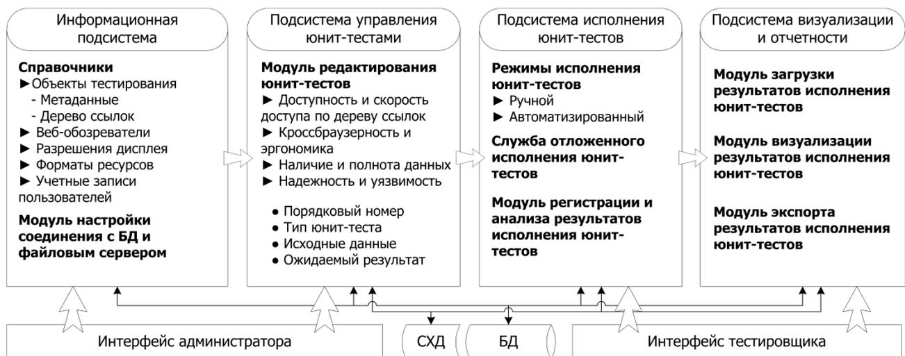
Функциональная архитектура системы автоматизированного тестирования корпоративных веб-приложений
